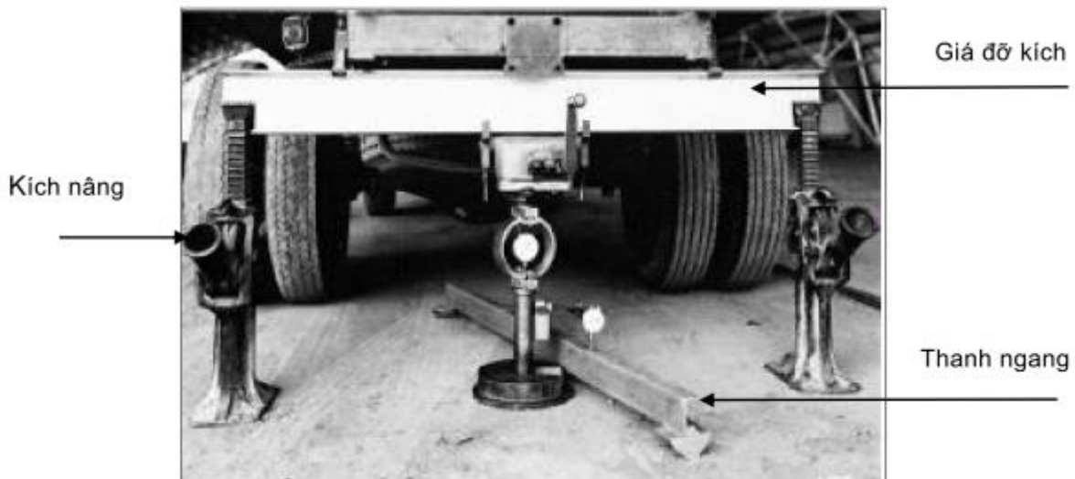
Hình 3 - Lắp đặt kích nâng cho xe tải
